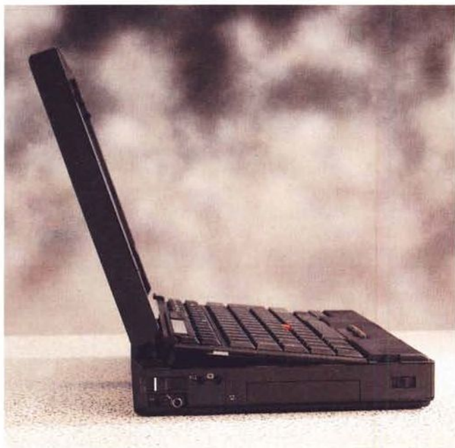
La tastiera dell'IBM ThinkPad (a sinistra) si solleva automaticamente aprendo il coperchio display. A destra il contenitore per utilizzare esternamente l'unità floppy disk del Toshiba Satellite Pro 400 con accanto il lettore di CD-ROM.
